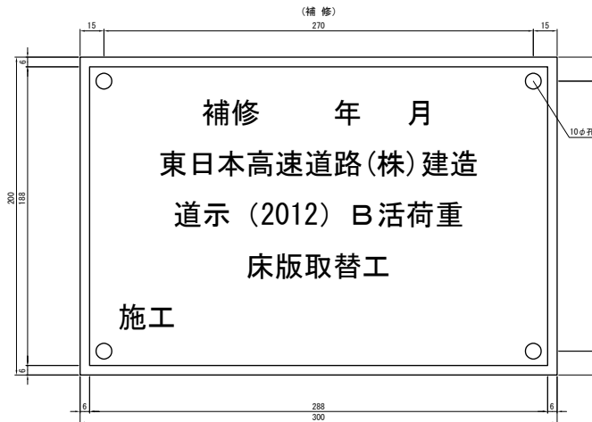
箱抜き正面図 S=1:10
